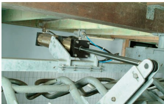
Подъемный цилиндр задействован только при выгоне животных - малоизнашиваемый, долгий срок службы
