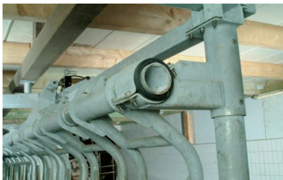
Нейлоновые втулки фронтального вала - исключительно надежны и не требующие обслуживания
