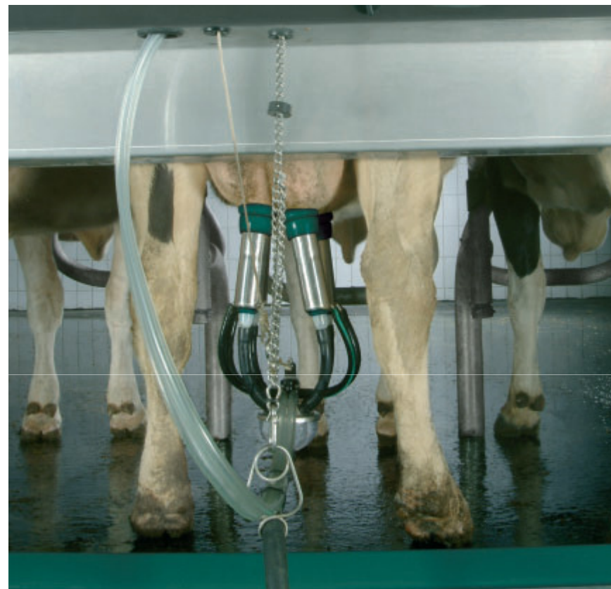
Counterbalance = гибкое ведение шланга - оптимальная позиция доильного аппарата на вымени - простота в применении
