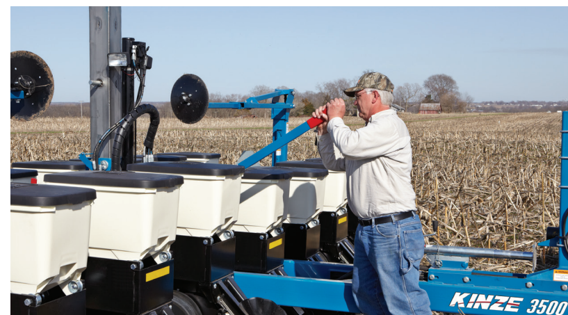
Подпружиненные эксцентриковые стопоры высевающей секции над центром Легко переключение за минуты с раздельного высева и на ряды стандартной ширины.
