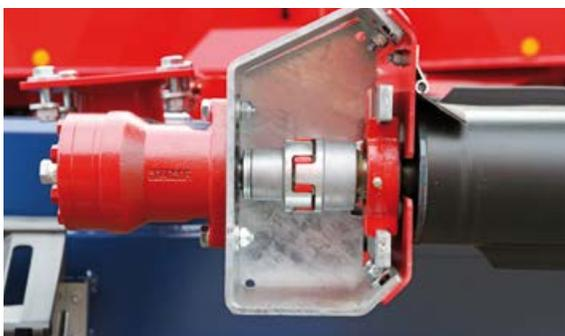
Сцепление между приводным двигателем и валом обеспечивает плавный ход и долгий срок службы.
