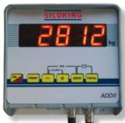
Суммирующая весовая система установлена серийно представляет собой простое решение для вывода точного актуального веса в процессе загрузки и раздачи корма. Весовой компьютер размещается на смесителе-кормораздатчике и может поворачиваться в любую сторону.
